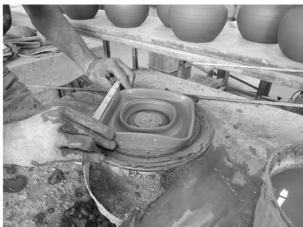
Fig. 7. Fasi della modellazione al tornio e della rifinitura a stecca della parte superiore con alto bordo quadrangolare e imboccatura centrale circolare che successivamente verrà saldata sul corpo cilindrico.
