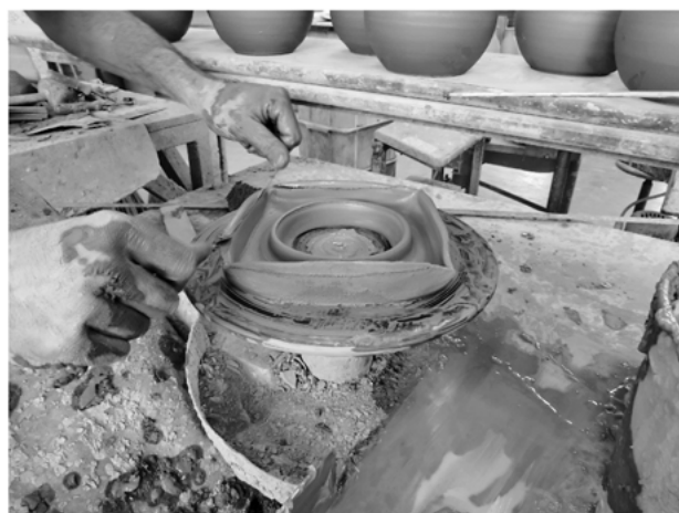
Fig. 7. Fasi della modellazione al tornio e della rifinitura a stecca della parte superiore con alto bordo quadrangolare e imboccatura centrale circolare che successivamente verrà saldata sul corpo cilindrico.
